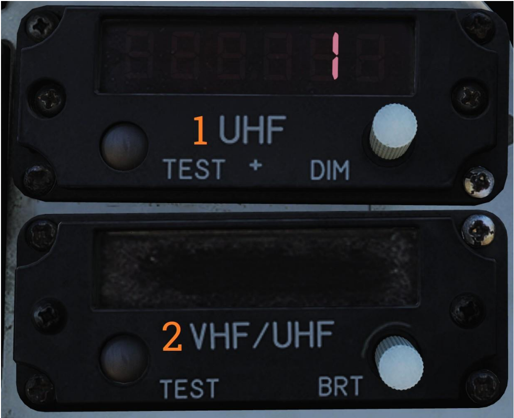
Indicadores remotos que muestran la frecuencia establecida o el canal de UHF 1 (AN/ARC-159) y V/UHF 2 (AN/ARC-182).
