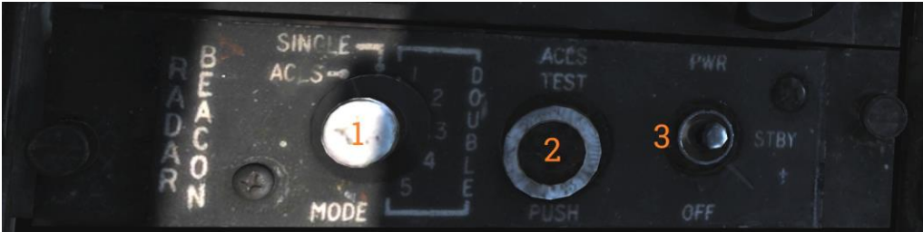
Panel de control de la baliza radar AN/APN-154.
