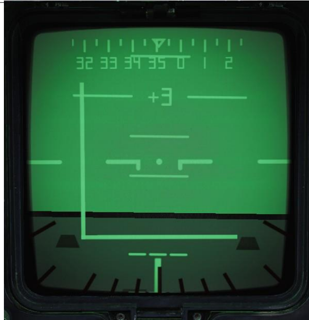
Fig. 12: VDI que muestra el modo de aterrizaje con AWL/PCD configurado como fuente de destino, ILS (ICLS) configurado como fuente de senda de planeo y localizador.
