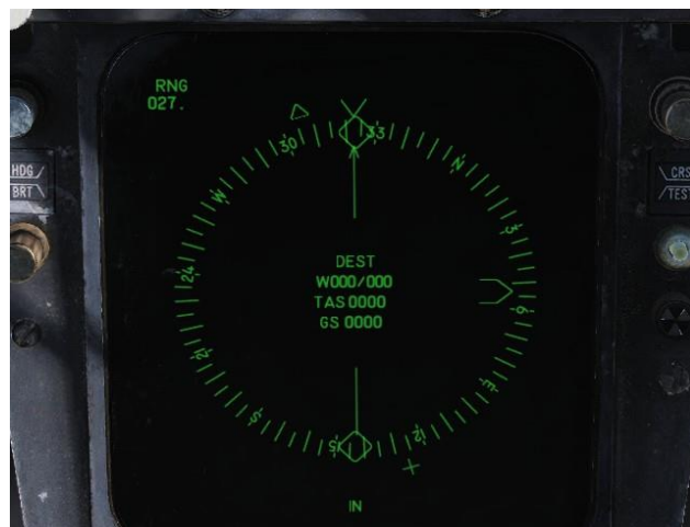
Fig. 9: HSD que muestra la pantalla de navegación para Crucero con el Waypoint 1 configurado como Destino.
