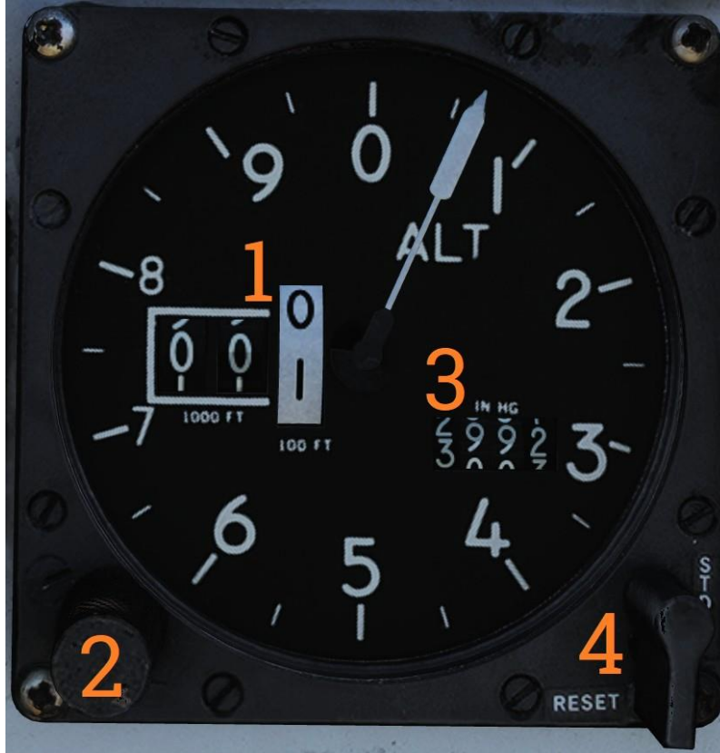
Control e indicador para el altímetro servoneumático.
