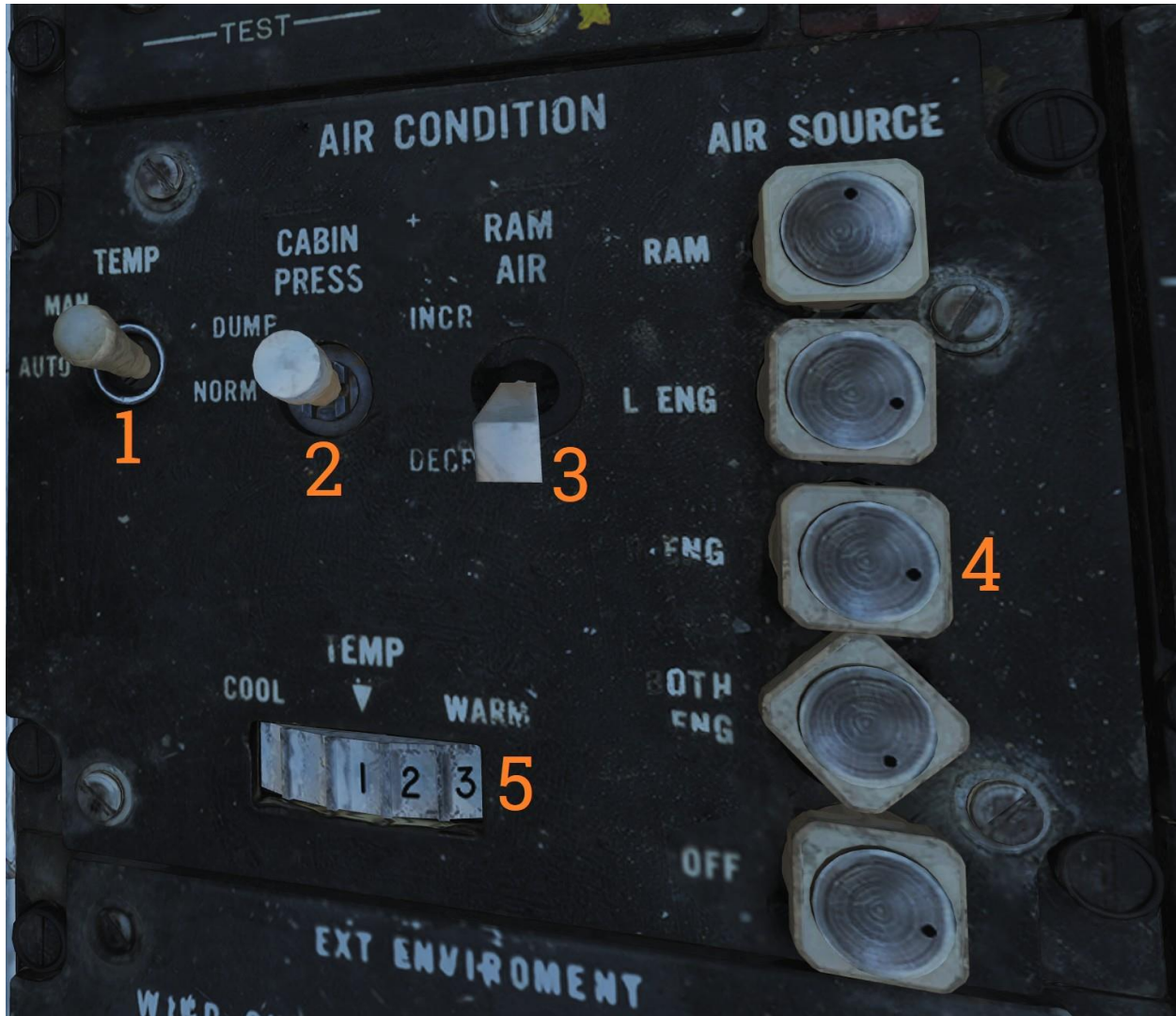
Panel de control del sistema de control ambiental (ECS).
