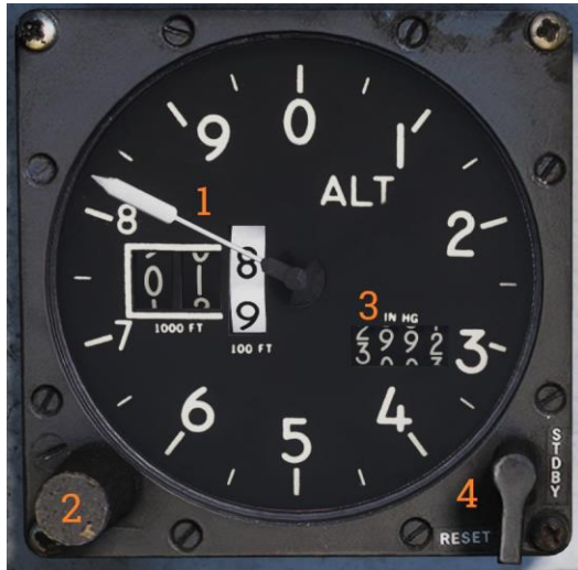
Control e indicador del altímetro servoneumático.
