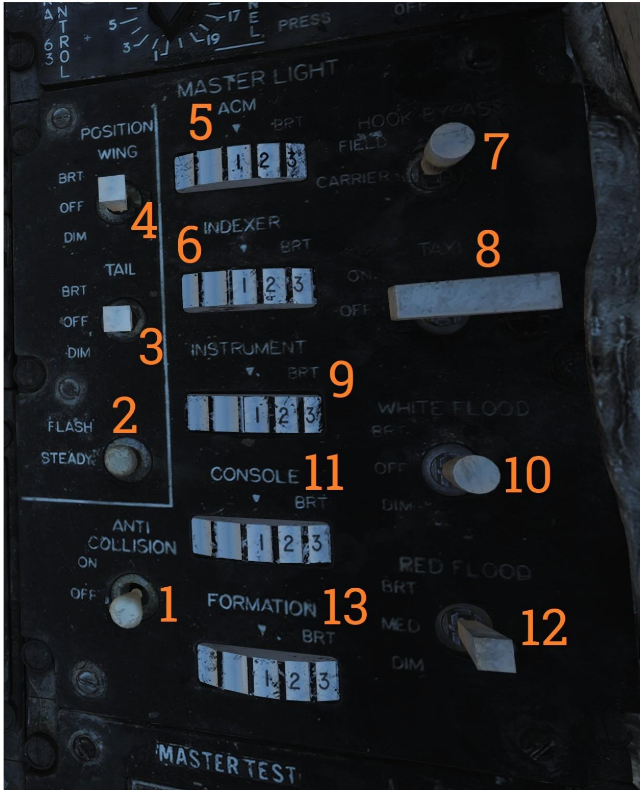
Panel de control de luces maestro, que controla la mayoría de las luces en el avión.
