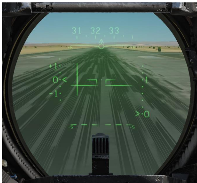
Fig. 10: HUD que muestra la pantalla del modo de aterrizaje con TACAN configurado como fuente de destino.
