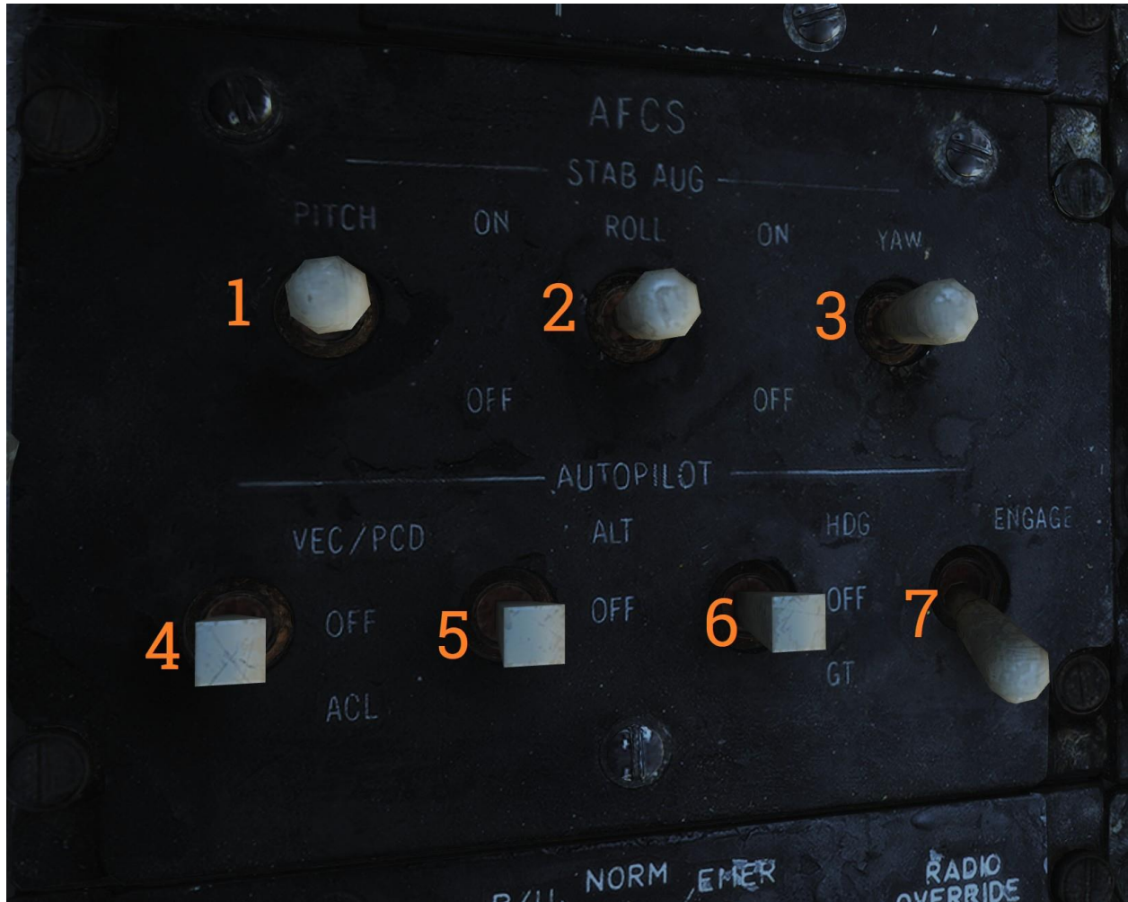
Panel de control para AFCS (Automatic Flight Control System) y piloto automático.
