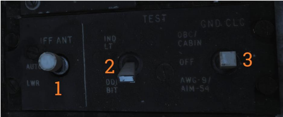
Panel que contiene controles para antena IFF, pruebas y enfriamiento en el suelo.
