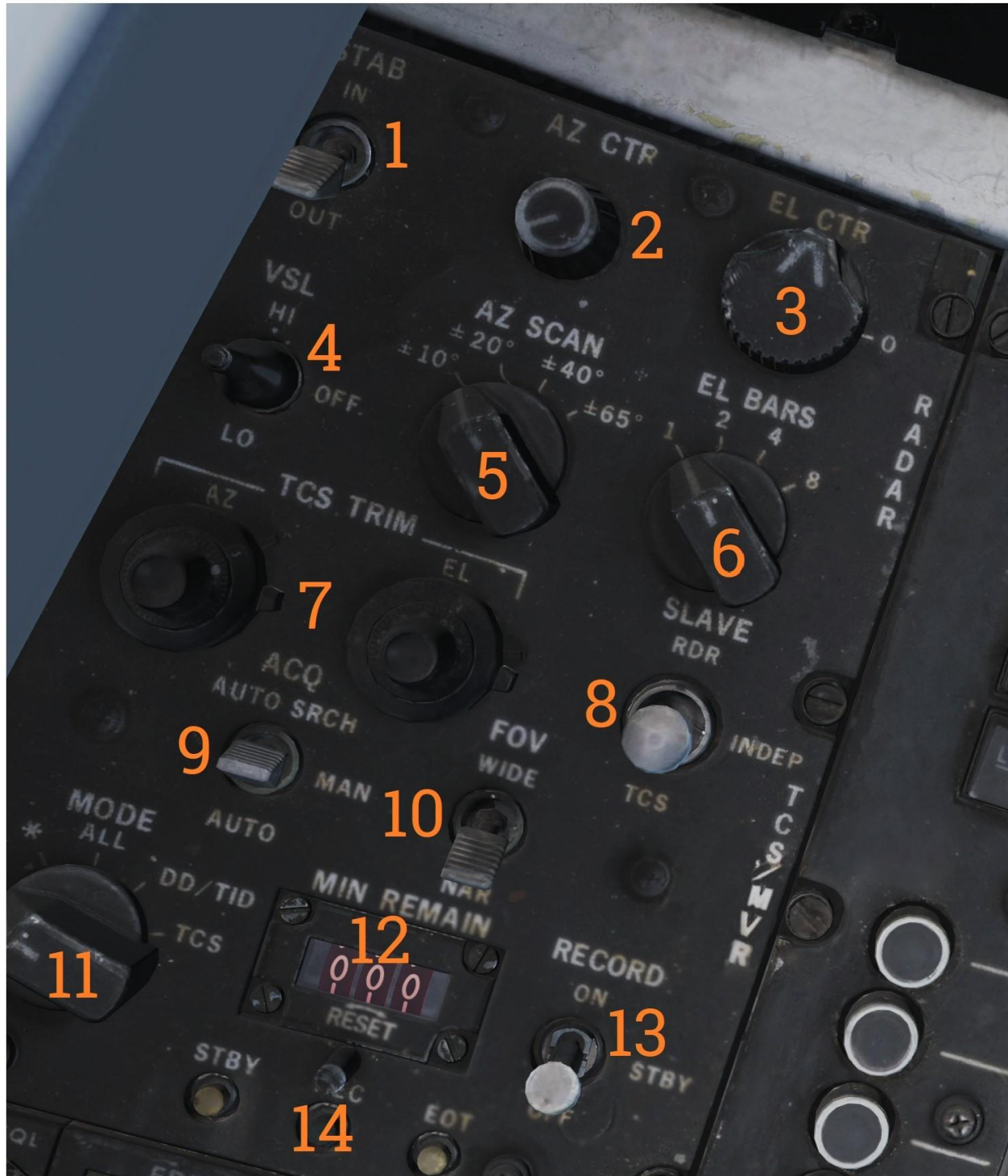
Panel de control para la configuración de escaneo AWG-9, el TCS y la grabadora de cinta de video aereo.
