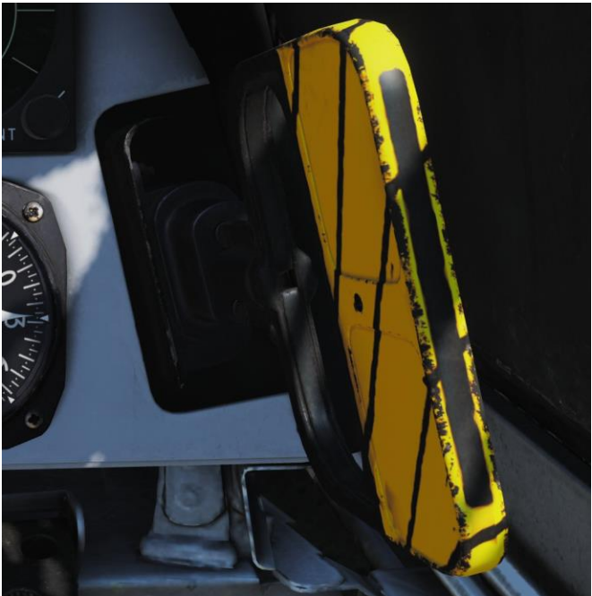
Mango utilizado para desechar manualmente la cupula.
