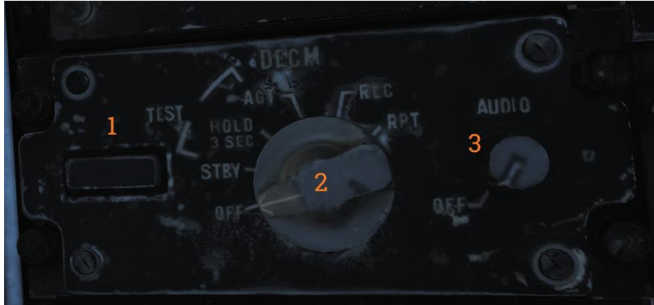
Panel de control del jammer DECM (AN/ALQ-126).
