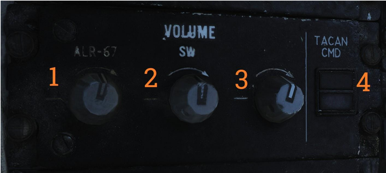
Panel de control de volumen a los auriculares del piloto y miembro de la tripulación en control de TACAN.
