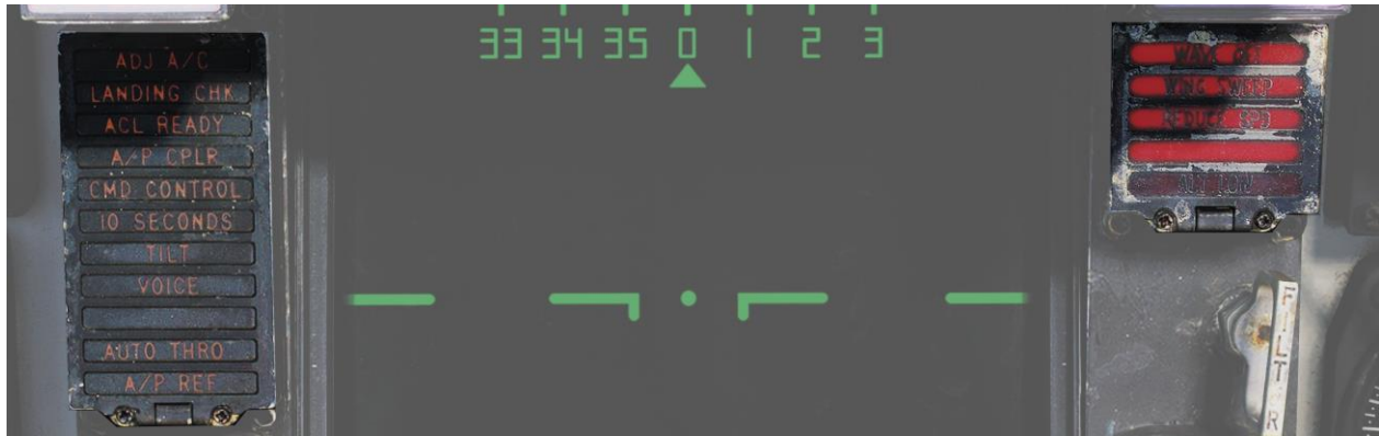
Luces de advertencia y precaución del Data link situadas en el panel VDI.
