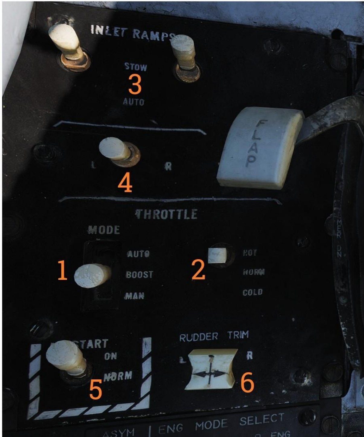
Panel de control para varios sistemas de motor, ajustes del acelerador y trimado del timón.
