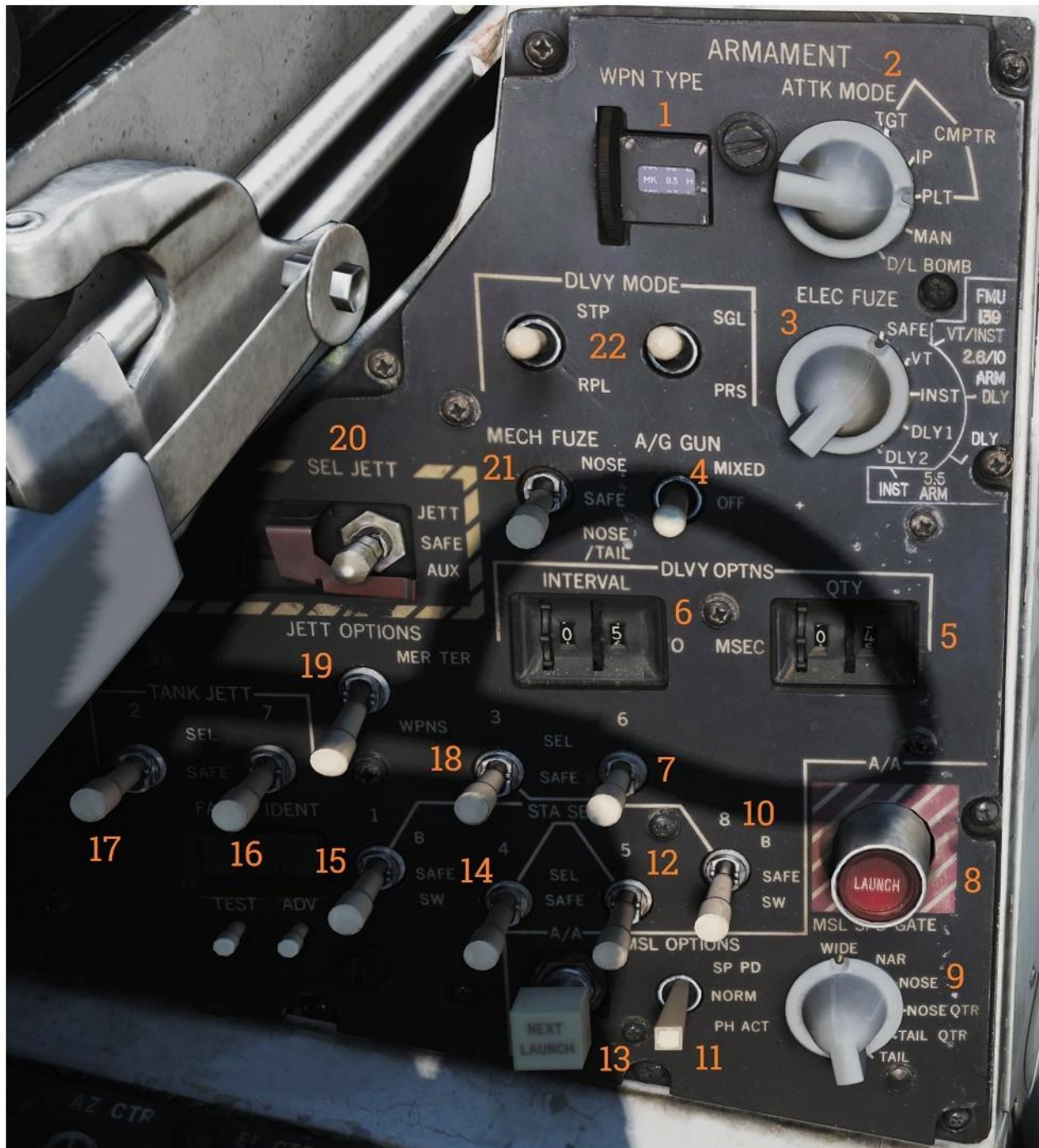
Panel de control de armamento principal en la cabina del RIO.
