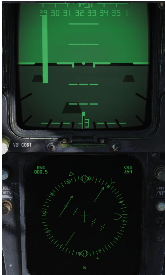
Fig. 8: VDI y HSD muestran pantallas de navegación para crucero con dirección TACAN seleccionada.
