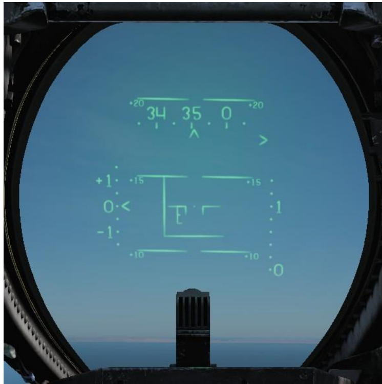
Fig. 11: HUD que muestra el modo de aterrizaje con AWL/PCD configurado como fuente de destino, ACL configurado como fuente de senda de planeo y localizador.
