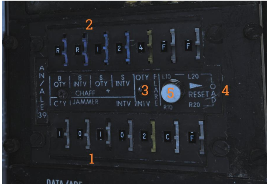
Panel de programación utilizado para programar el inventario de contramedidas actual en AN/ALE-39.
