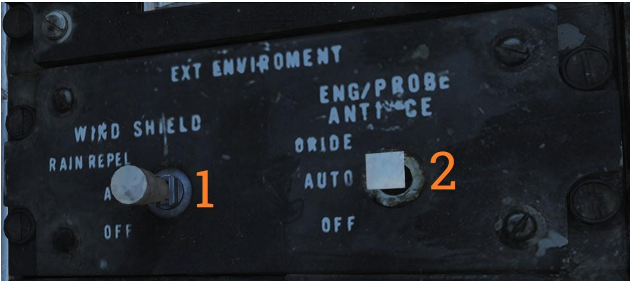
Panel que controla el aire del parabrisas y los ajustes externos anti hielo.
